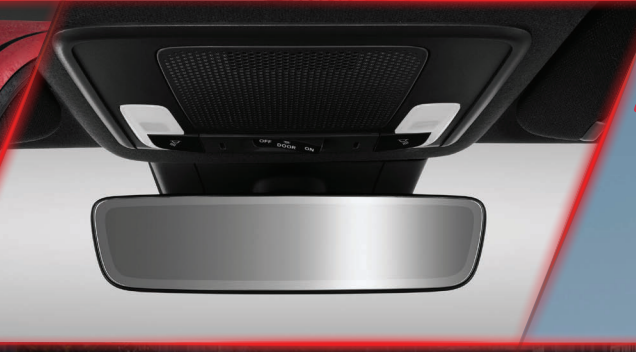
Gương chiếu hậu chống chói, tự động làm mờ khi có ánh sáng đèn pha xe khác chiếu vào (RS, L).
